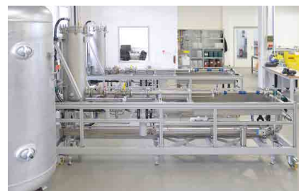
Systèmes d'étalonnage à piston (2x) 20 ml/min – 1.200 l/min
