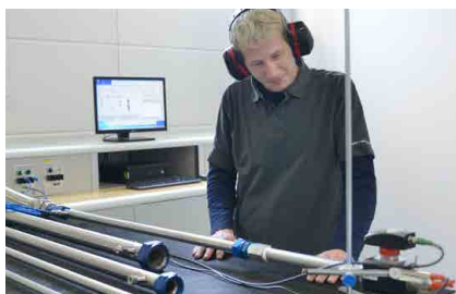
Banc d'essai pour organes déprimogènes 8 l/min – 15.000 l/min
